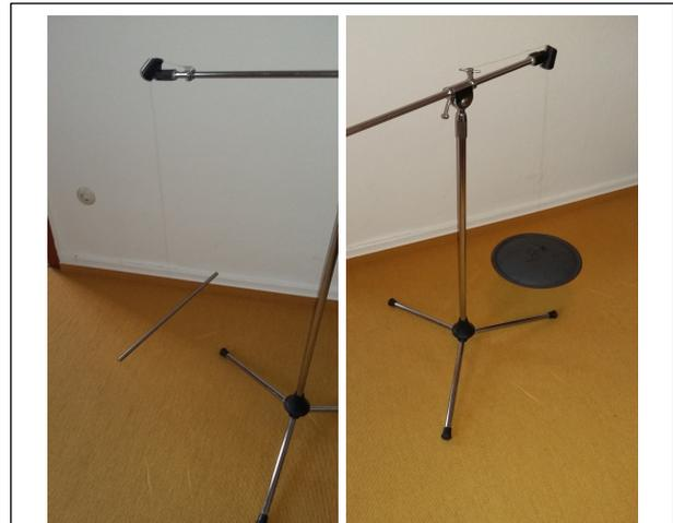
2 Bestimmung des Torsionsmoduls  $G$  (links); Bestimmung des Trägheitsmoments eines Topfdeckels.
